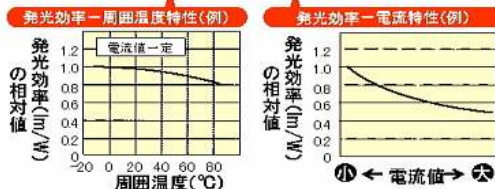
図-3 LEDの器具組込時の発光効率低下要因
